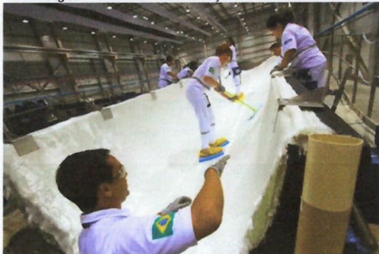
Figura 7 - Processo de laminação manual de tecidos
