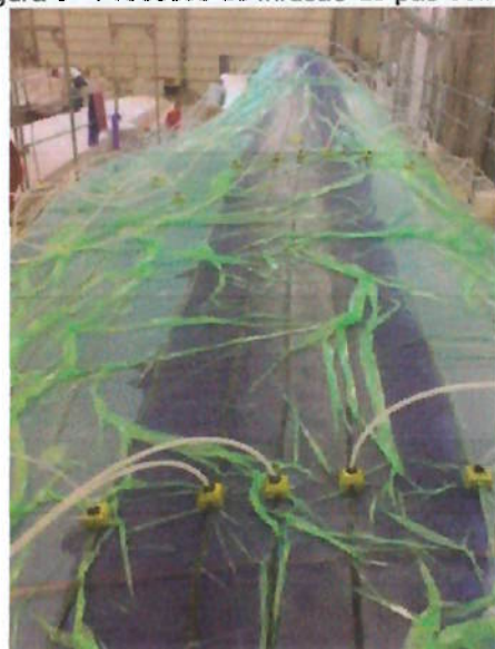
Figura 9 - Processo de infusão de pás eólicas.
